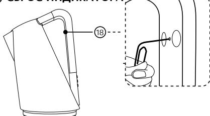
Если на индикаторе не отображаются правильные функции, необходимо выполнить его сброс. Это делается в целях безопасности для обновления всей памяти внутреннего микроконтроллера. Поставьте чайник Vera на блок электропитания (5). Включите его в сеть питания. С помощью металлической скрепки или зубочистки нажмите кнопку сброса (18) и удерживайте ее нажатой в течение 5 секунд. Индикатор вернется в исходное состояние и все настройки (часы, таймер и температура) сбросятся.
